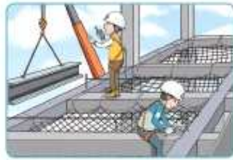
⑥ 안전대 착용 시 안전대 부착설비 설치
