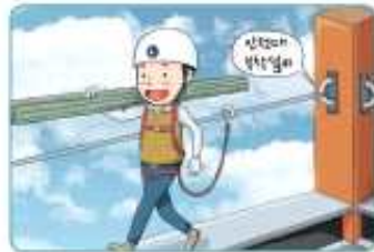
⑥ 안전대 착용 시 안전대 부착설비 설치
